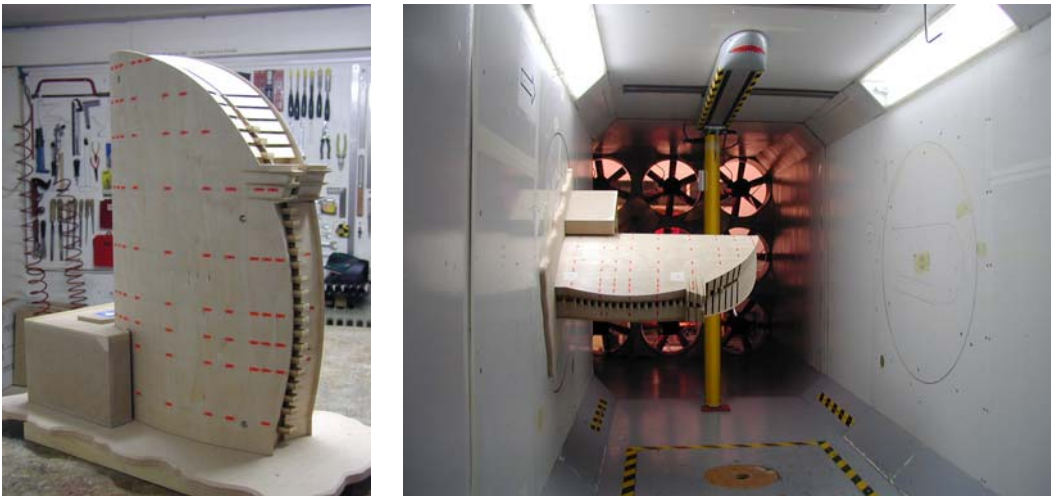
Figs. 3a y 3b: Vistas de la maqueta en el interior del túnel de viento de la E. T.S.I. Aeronáuticos de Madrid
