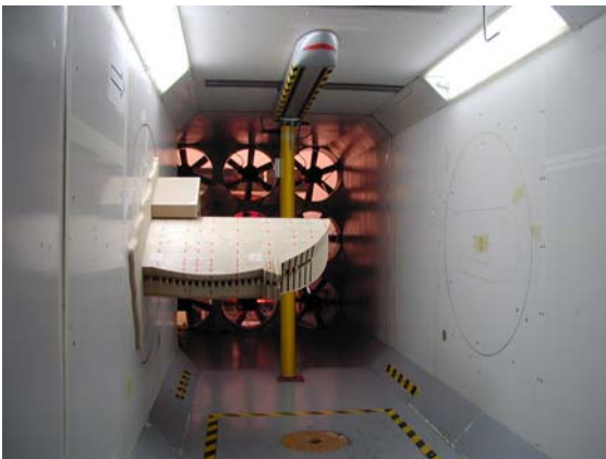
Fig. 9: Ensayo en túnel de viento del Hotel Vela
