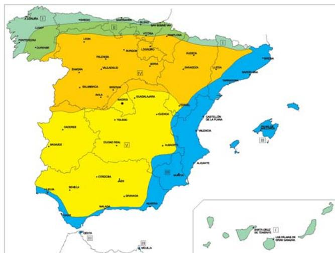
**Figura 1. Zonas para la obtención de la variación uniforme de temperatura del puente (IAP-98).**
