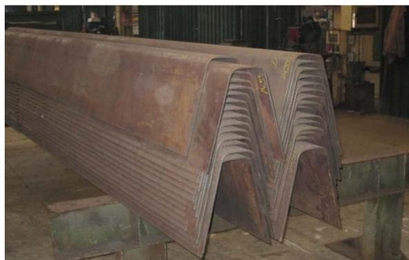
**Figura 3** Rigidizadores longitudinales plegados
