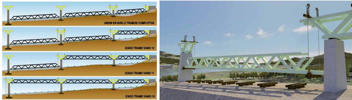
Figuras 7a y 7b. Secuencia del proceso de izado de los vanos laterales 10, 11 y 12.
