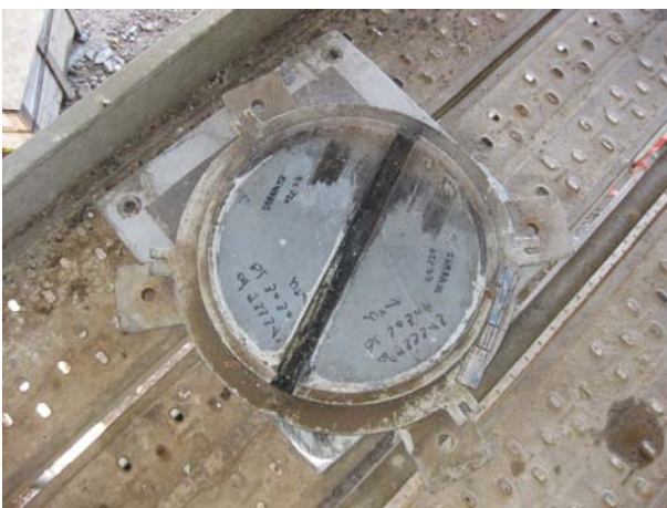
Figuras 20 y 21. Aparatos de apoyo de estribo, una vez retirados. Se puede observar cómo la parte inferior del apoyo, el pistón, se encuentra totalmente deteriorado debido a la insuficiencia de carrera de las bandejas deslizantes. También se observa el precario estado de conservación de la bandeja de acero inoxidable correspondiente a otro de los apoyos de estribo.
