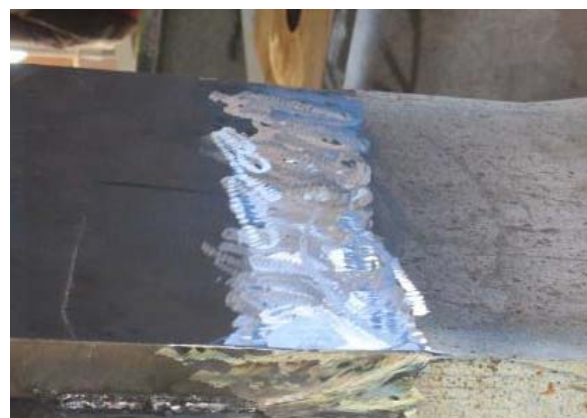
Figura 3 Soldadura amolada sin sobreespesor
