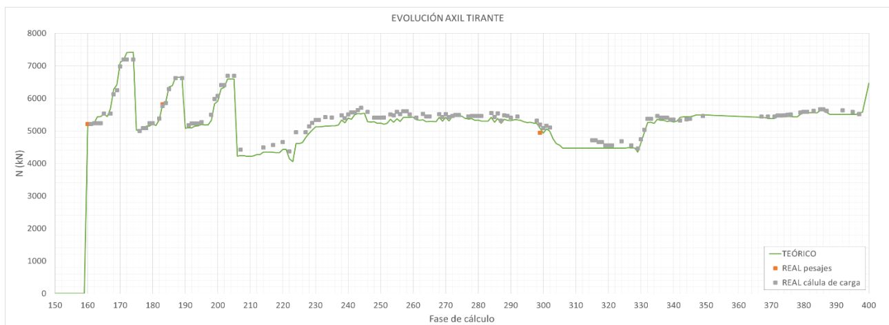
Figura 11. Evolución del axil del tirante TRO-9 sur con la construcción. Modelo de seguimiento (verde), valor de la celda de carga (gris) y pesajes realizados (naranja)
