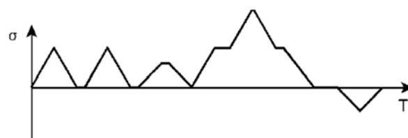
Figura 5 Ejemplo de histórico de tensiones en un detalle (Figura A.1 b) de UNE-EN 1993-1-9)
